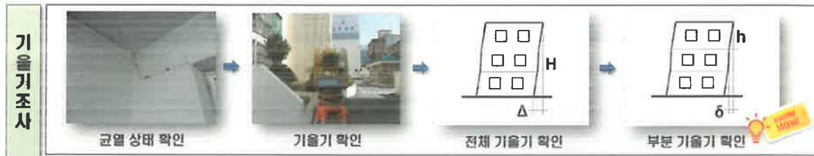
[그림 8] 상부에서 하부로 결함조사 후 기울기 확인
